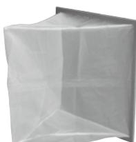
防虫ネットフィルタ[セット品]は、押さえ金具で容易に着脱が可能です。防虫ネットは樹脂枠に面ファスナーで留めてあるので交換は容易にできます。防虫ネットは、3~5回程程度の洗浄再生が可能です。
