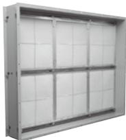
フィロシステムのVA・CMは、横スライドメンテナンス方式のフィルタケーシングです。フィルタ押さえ付け機構は、フィルタの上下を面で押さえ、ガスケットを押しつぶすことにより、虫の侵入を防ぎます。
