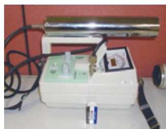
放射線量の測定器 (NaI (Tl) シンチレーションサーベイメータ)
