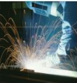
アーク溶接時に発生する白い煙が溶接ヒューム
