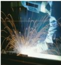
アーク溶接時に発生する白い煙が溶接ヒューム
