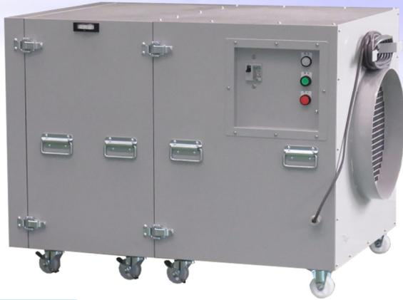
ネガティブクリーンユニット®は、アスベストなどの特定粉じんを使用している解体工事現場で、粉じんの汚染拡大を防止するため、隔離・養生した作業区域の内部を負圧に保つ装置です。
