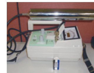
放射線量の測定器 (NaI (TI) シンチレーションサーベイメータ)
